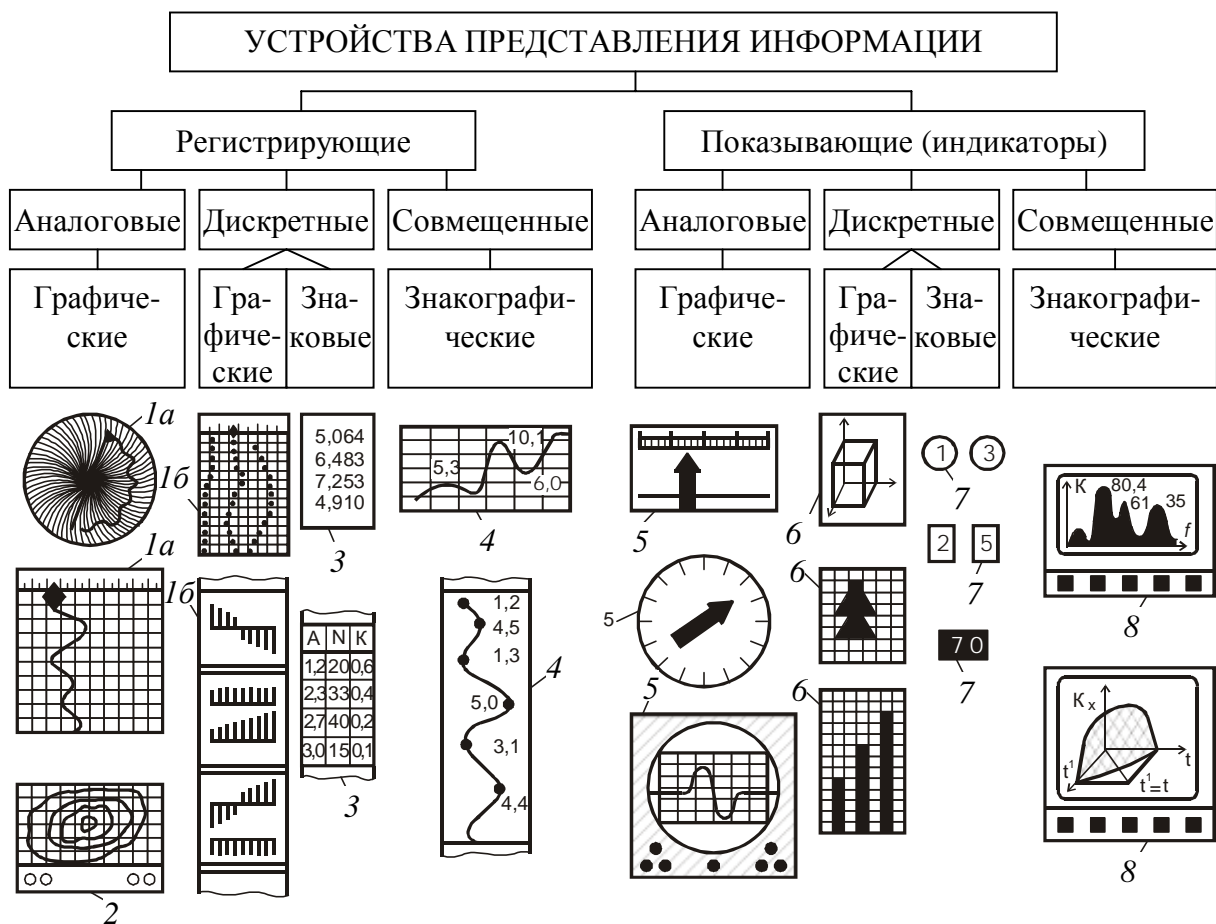
Рис. 10.5. Классификация устройств представления информации: 1 – самопишущие одноканальные (а) и многоканальные приборы (б); 2 – координатные построители; 3 – цифровые регистрирующие приборы; 4 – знакографические устройства; 5 – приборы показывающие; 6 – построители эпюр и графиков; 7 – цифровые индикаторы; 8 – дисплеи
