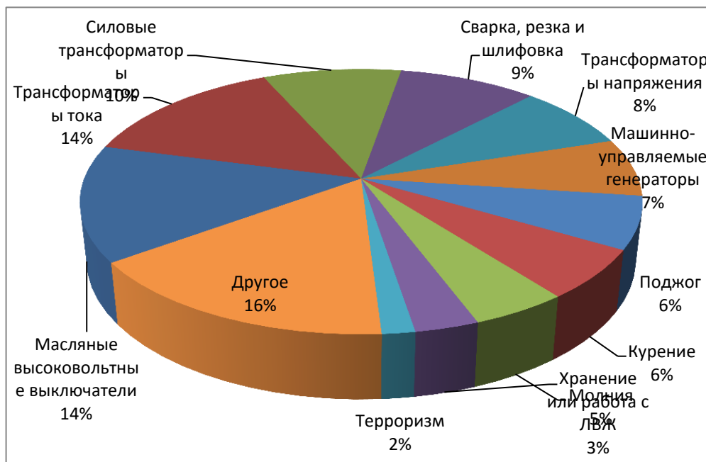
Типы и источники возникновения пожаров на подстанциях
