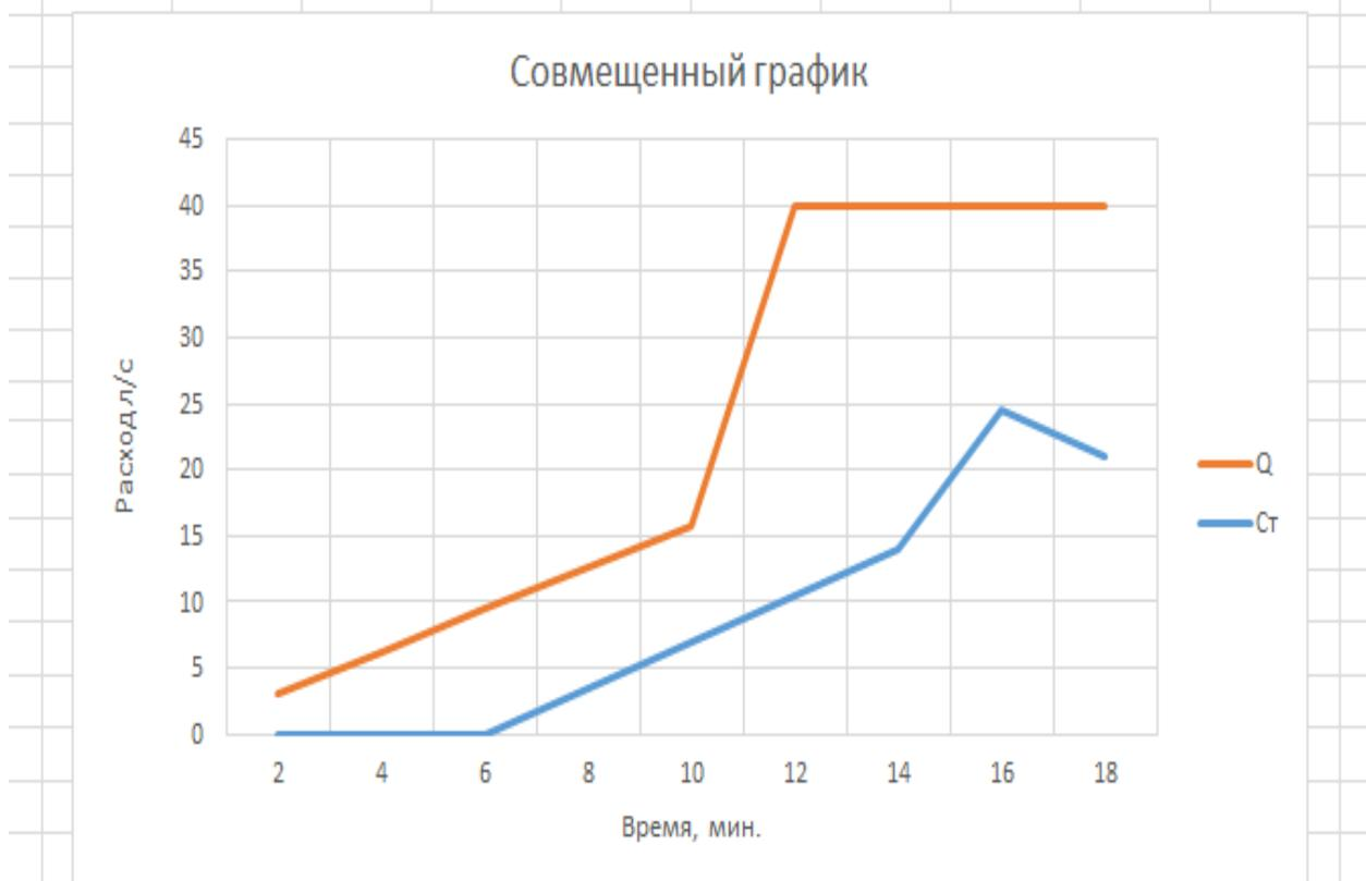
Рисунок 11. Совмещенный график расчета сил и средств тушения пожара на территории маслохозяства ГЭС
