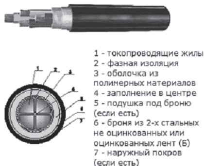
Рис. 3.4. Четырехжильный кабель в разрезе
