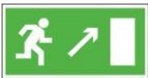
Е 05 Направление к эвакуационному выходу
