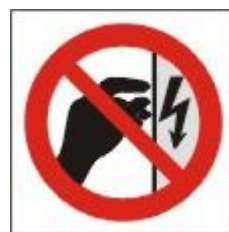
Р 09 Запрещается прикасаться Корпус под напряжением
