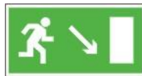
Е 07 Направление к эвакуационному выходу
