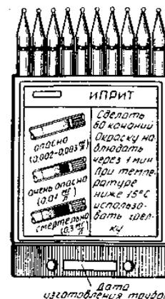
*Газоанализатор универсальный (УГ-2).* Предназначен для измерения концентрации вредных газов и паров в воздухе рабочей зоны производственных помещений и на территории химических предприятий.
