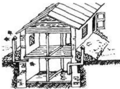
ПРУ в подвале
