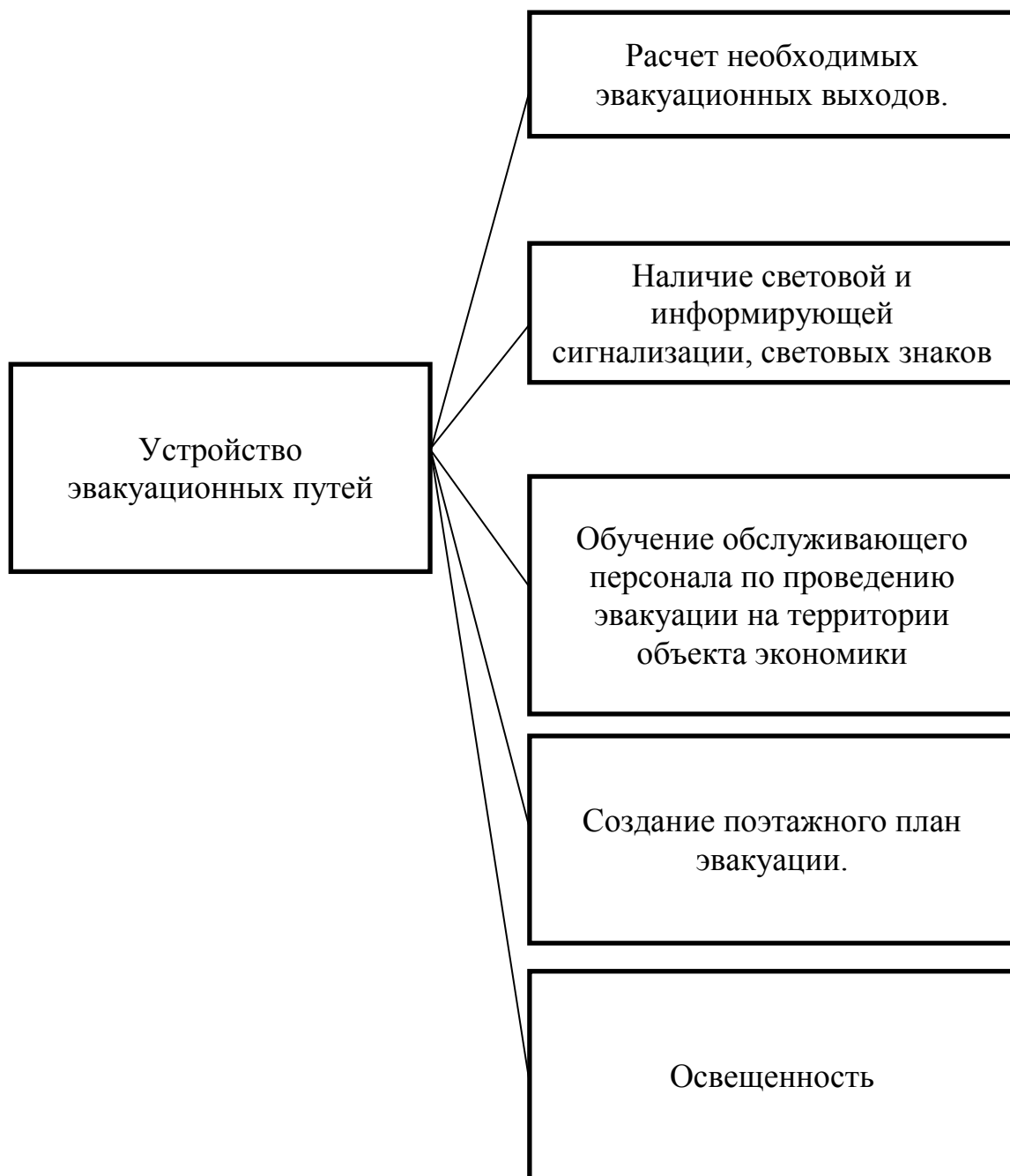
Рисунок 7. Основные вопросы устройств эвакуационных путей.
