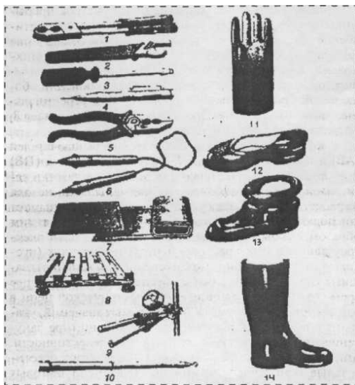
Рис.3.13. Электротехнические средства, применяемые в электроустановках: 1 – клещи для вставки предохранителей; 2 – гаечный ключ; 3 – отвертка; 4, 6, 10 – указатели напряжения; 5 – пассатижи; 7 – резиновый коврик и дорожка; 8 – изолирующая подставка; 9 – токоизмерительные клещи; 11 – перчатки резиновые диэлектрические; 12 и 13 – галоши и боты диэлектрические; 14 – сапоги диэлектрические
