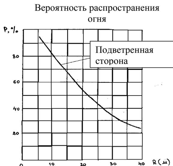
**Рис. 3.10.** (в) Вероятность распространения пожаров от расстояния между смежными зданиями и наличия ветра.
