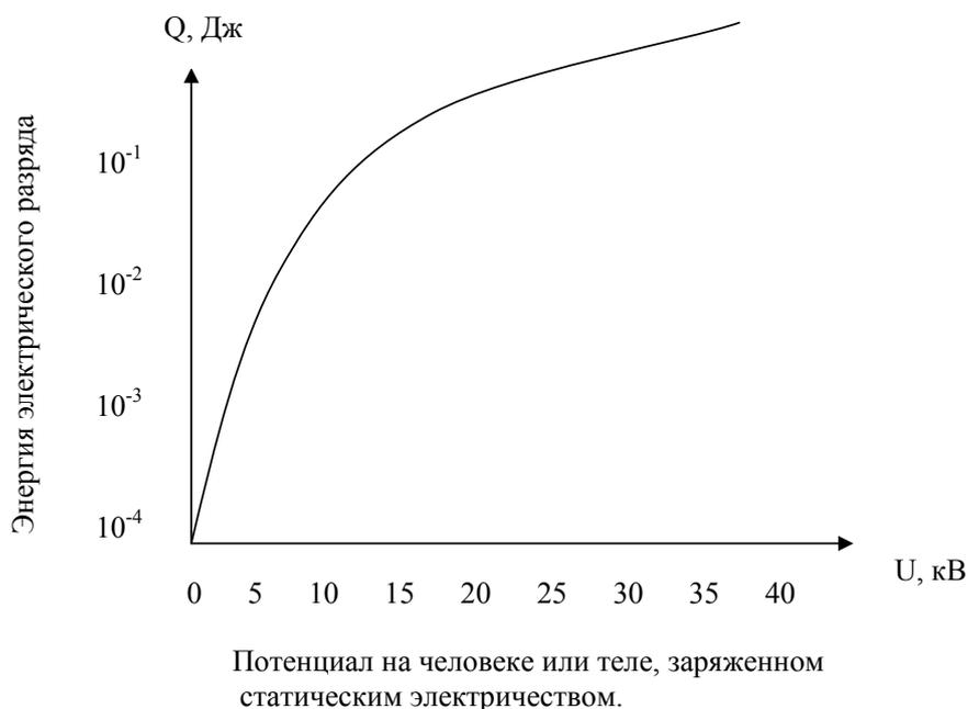
**Рис. 3.5.** Зависимость энергии электрического разряда от потенциала зарядов статического электричества.
