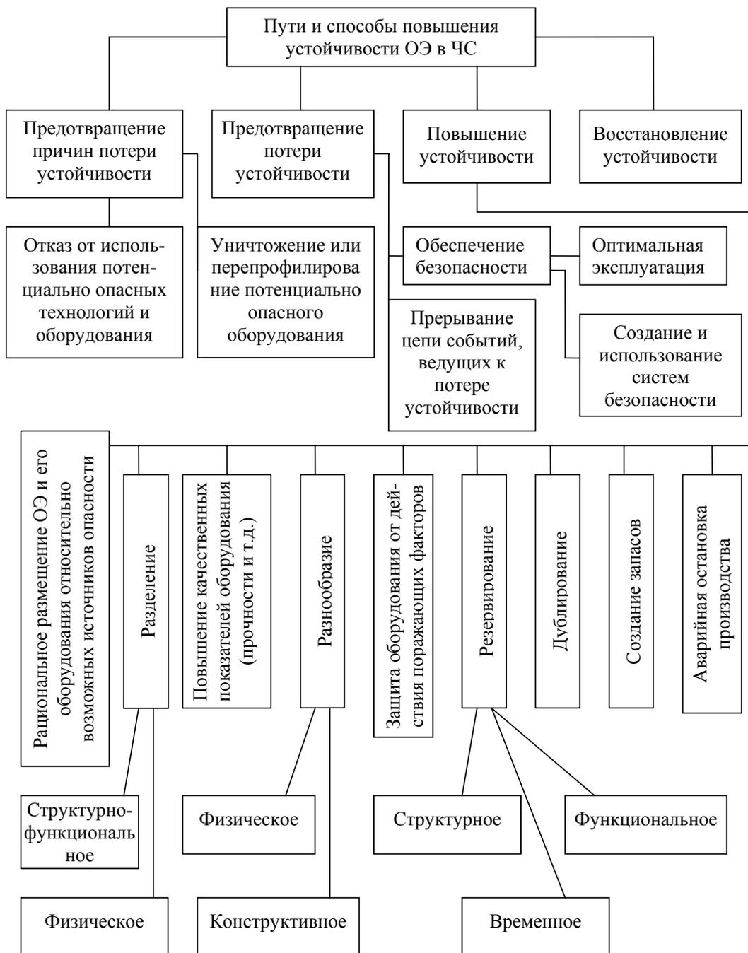
**Рис. 4.1.** Пути и способы обеспечения устойчивости работы ОЭ в ЧС.
