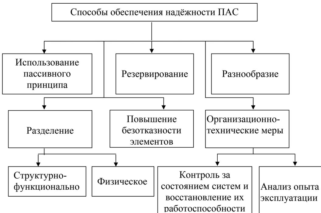
**Рис. 2.20.** Способы обеспечения надёжности противоаварийных систем
